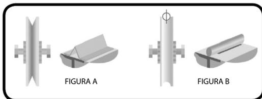
**3º Passo:** Verifique se a folha do portão não emperra no movimento de abertura e fechamento. O trilho de deslizamento do portão deverá ser perfeitamente retilíneo, nivelado, desobstruído periodicamente de qualquer elemento ou sujeira que dificulte o deslizamento das roldanas em toda sua extensão, como mostra a figura abaixo.
