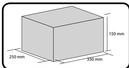
**2º Passo:** As dimensões da base deverão ser apropriadas para as dimensões do automatizador. A base de concreto deverá ficar a uma distância de aproximadamente 25 mm da face da folha do portão.
