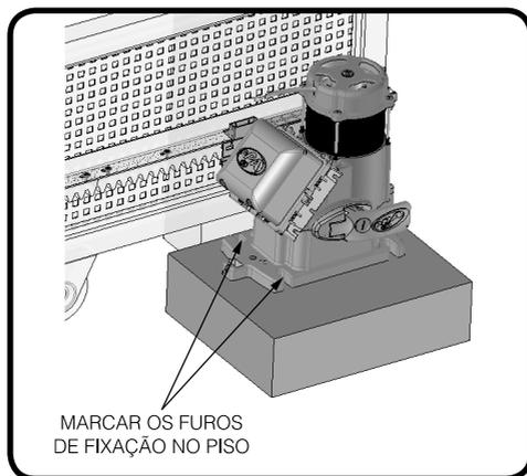
**5º Passo:** Faça a furação para a fixação, posicionando o automatizador alinhado ao portão. Antes de apertar os parabolts, movimente o portão, verificando se o mesmo não encosta no automatizador no decorrer de seu percurso. Caso isso ocorra, recue o automatizador.
