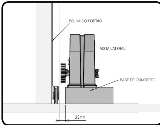
**3º Passo:** Atendidas as condições, abra totalmente o portão e posicione o automatizador próximo à face da folha do portão, obedecendo a medida de 50 mm entre a extremidade da folha e o automatizador.
