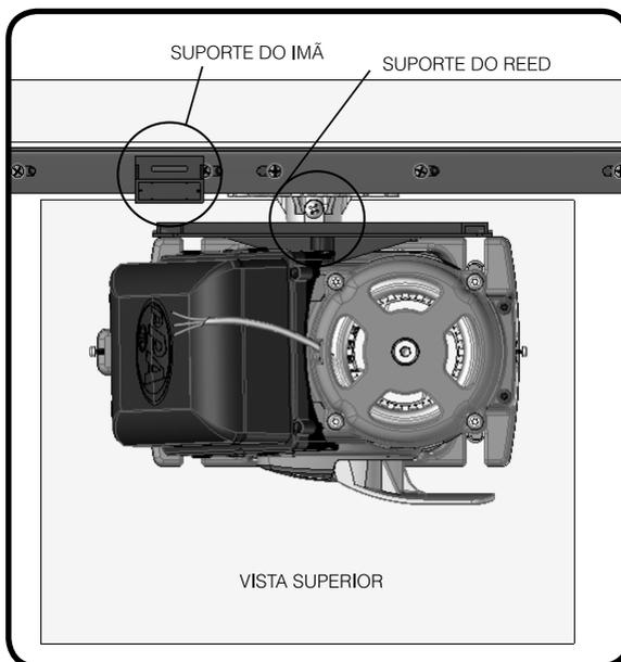
**3º Passo:** Acione o motor e observe se os REED's estão desligando corretamente. Caso haja necessidade, inverta o conector da placa. Depois de fixados os suportes dos ímãs, faça os ajustes finais, deslocando-os para a direita ou para a esquerda, conforme o ajuste desejado.
