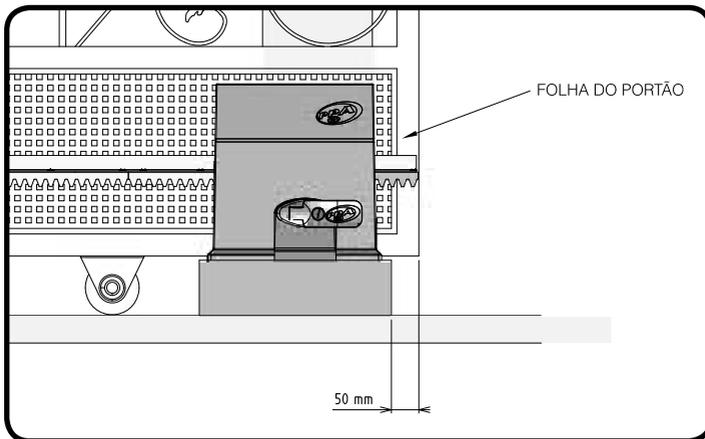
**4º Passo:** Faça o pré-alinhamento do automatizador ao portão, posicionando a cremalheira sobre a engrenagem e encostando o conjunto ao portão. Em seguida, marque os furos de fixação no piso ou base de concreto.
