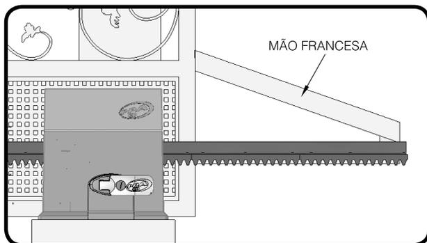
**9º Passo:** Após a fixação da cremalheira, fixe definitivamente o automatizador no piso ou base de concreto, apertando definitivamente os parafusos.
