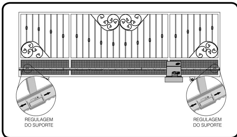
**4º Passo:** Para finalizar a instalação do automatizador, é obrigatório, antes do funcionamento do mesmo, parafusar a carenagem com 2 parafusos 3,5 x 16 mm (disponível no kit).
